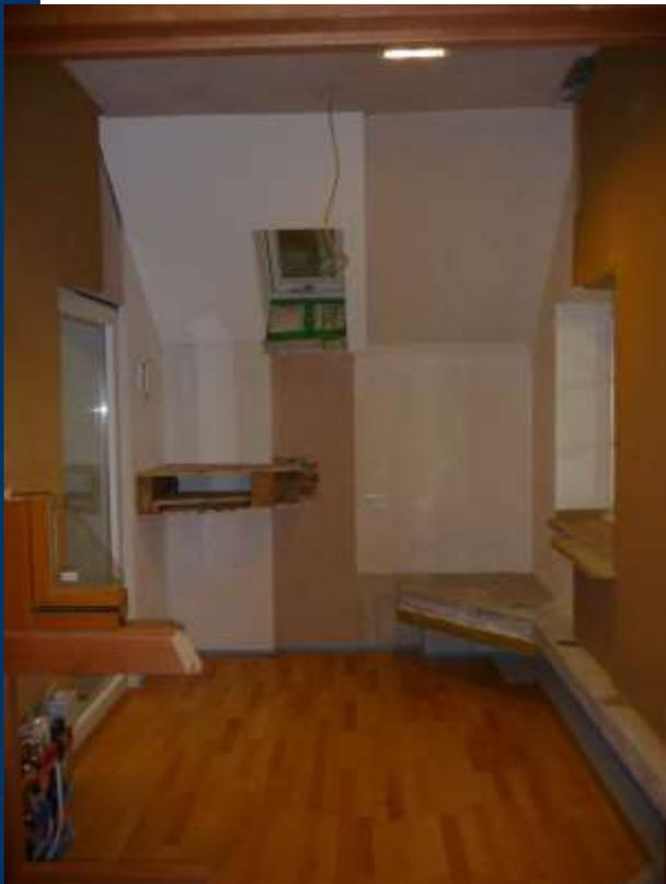
In der Klimakammer sind 5 verschiedene Innendämmsysteme im Maßstab 1:1 eingebaut.
